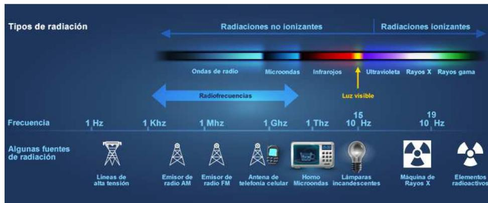
Figura 2. 2: Escala de las longitudes de onda del espectro electromagnético.
