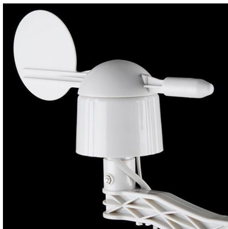
FIGURA 3. 10: sensor de dirección de viento Fuente: (saylor academic, 2016).
