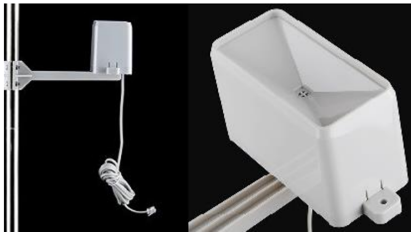
FIGURA 3. 8: Pluviómetro usado en el proyecto Fuente: (saylor academic, 2016).
