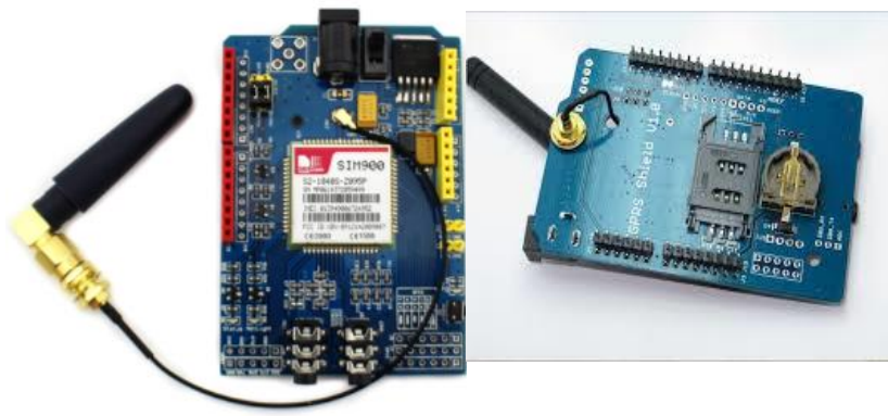
FIGURA 3. 4: módulo GSM/GPRS Fuente: Arduino 2016
