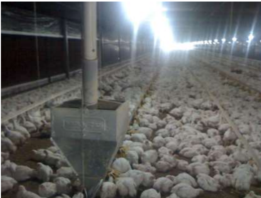
Vista interior, Bandeja de distribución de balanceado, línea de alimentación (tornillo sinfín) y comederos. A la derecha bebederos (nipples). A la izquierda vista interna del panel de humedad.
