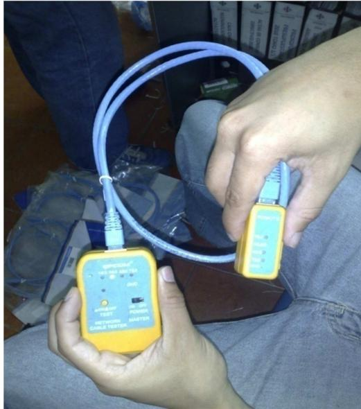
**Figura 3.12 Pruebas de continuidad de los *patch cord*.**
